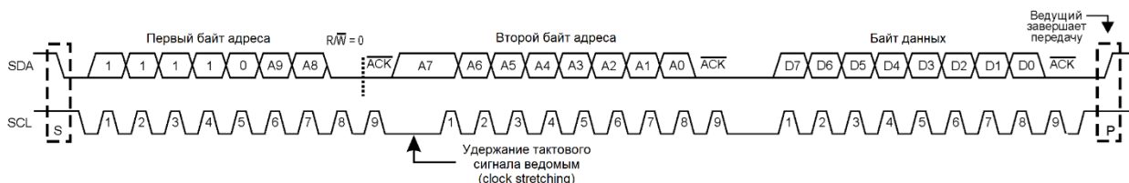
Рисунок 105 – Передача по I2C в 10-битном режиме
